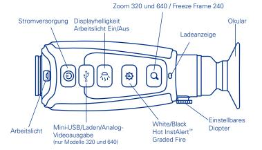
**Ein/Aus-Taste** – Die Scout III hat drei Energiezustände: Ein, Aus und automatische Abschaltung.
